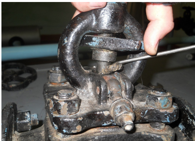
Рисунок 5- Крючком очищаем сальниковую камеру от остатков старой набивки.
