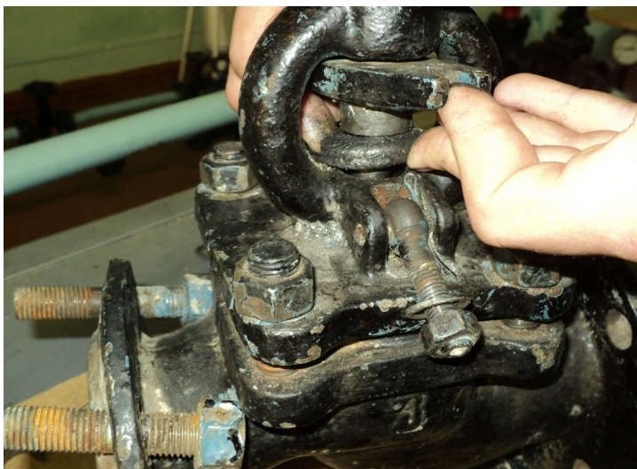
Рисунок 10- Заполнив сальниковую камеру кольцами набивки, вставляем нажимную втулку и обжимаем набивку.
