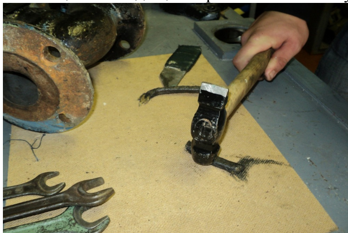
Рисунок 8 -На специальной дощечке разбиваем набивку молотком.
