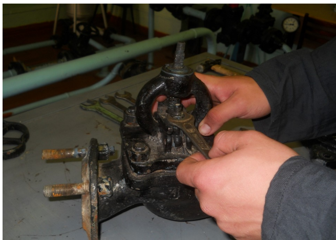
Рисунок 4- Извлекаем нажимную втулку из камеры сальника.
