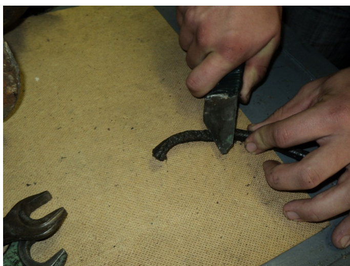
Рисунок 7 -Набивку нарезают отдельными кусками с косыми срезами длиной, равной диаметру шпинделя.
