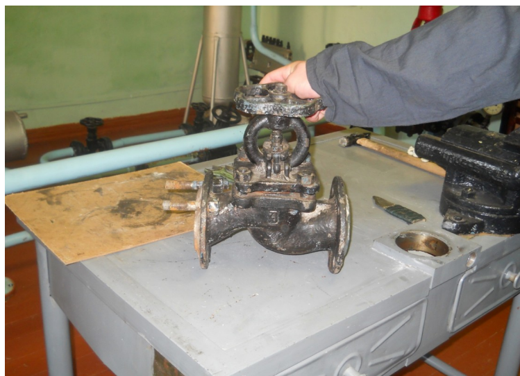
Рисунок 13- Окончательно затяжку сальника регулируют при пробном пуске при рабочей температуре.
