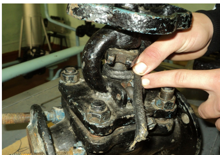
Рисунок 7 -Набивку нарезают отдельными кусками с косыми срезами длиной, равной диаметру шпинделя.
