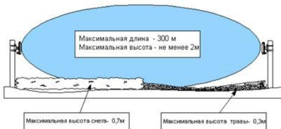
Рисунок 3. Зона обнаружения радиоволнового линейного извещателя Р-300
